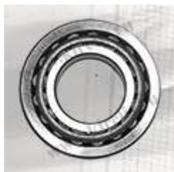
Подшипники радиально-упорные с коническими роликами предназначены для восприятия одновременно действующих радиальных и осевых нагрузок. Допустимая частота вращения значительно ниже, чем у подшипников с короткими цилиндрическими роликами, а способность к восприятию осевой нагрузки определяется углом конусности наружного кольца. С увеличением угла конусности осевая грузоподъемность возрастает при уменьшении радиальной. Перекос вала относительно оси корпуса недопустим.
